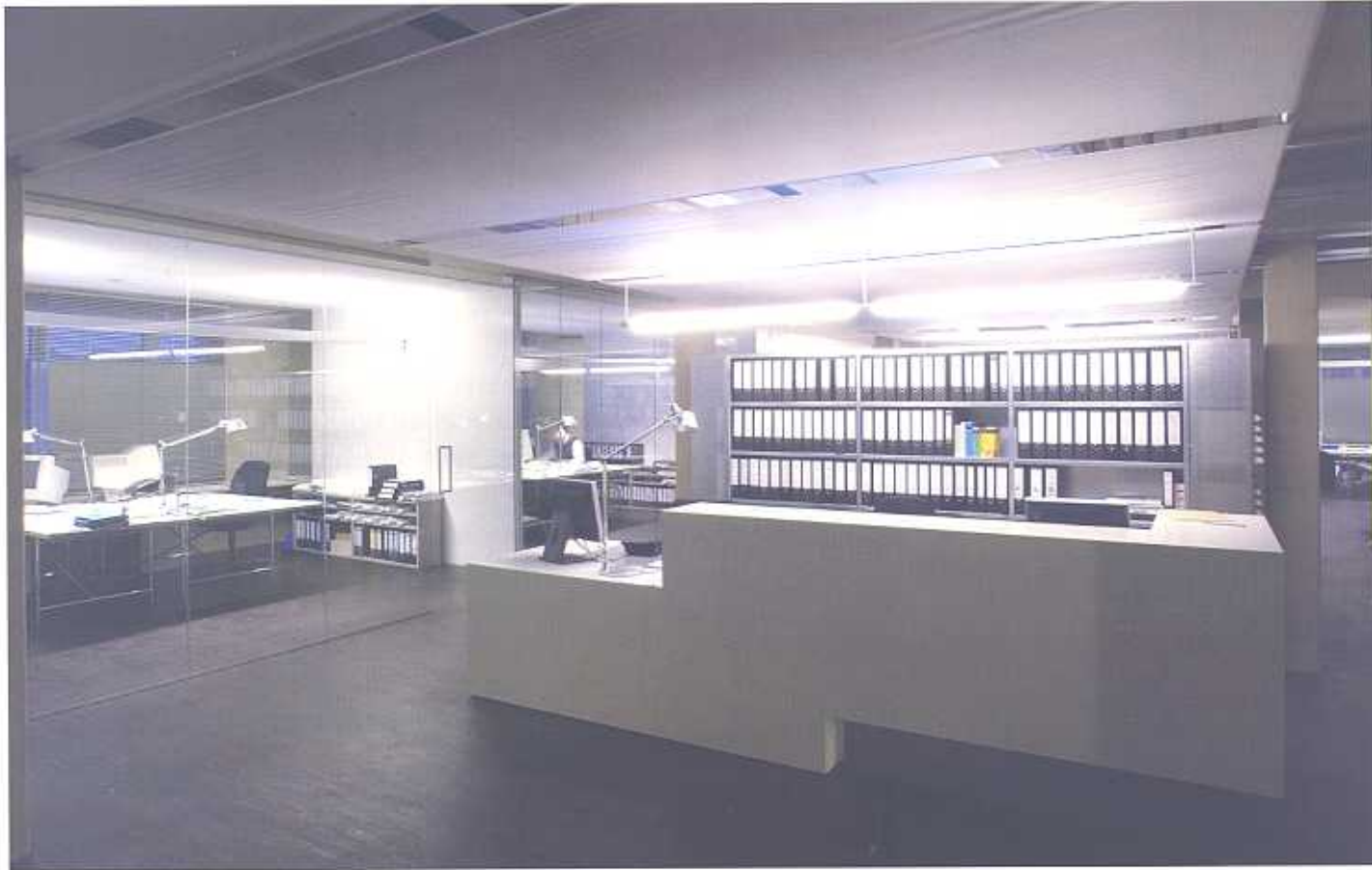
3. Die optimierte Tageslichtnutzung in Kombination mit einem Lichtlenksystem und einer tageslichtabhängigen Beleuchtungssteuerung. Die Lichtlenkjalousien tragen das Tageslicht möglichst tief und gleichmäßig in den Raum. Transparente Trennwände zwischen Büro und Kombizone versorgen auch innenliegende Zonen mit Tageslicht. Kunstlicht wird in Abhängigkeit vom Tageslichtangebot energiesparend gesteuert.
